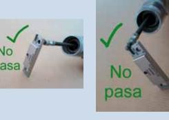
19 Verificar que no hay daños visibles en la unión entre la cabecilla macho y el cable. Comprobar la alineación entre la cabecilla y el cable
