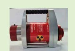
Verificar la limpieza del contenedor, comprobando que el tetón de la conexión con el telemando está en su posición
