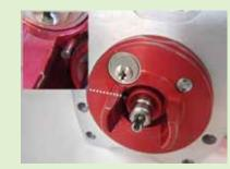
10 Comprobar que al presionar el botón de la parte delantera, el tapón es expulsado hacia delante y baja libremente
