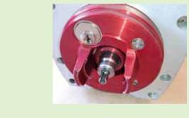
Verificar que el terminal hembra del porta-fuentes asoma completo por el conector trasero y no tiene daños (partes rotas o deformadas). Si hay alguna duda, verificarlo con la galga
