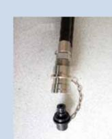
18 Comprobar la limpieza en el anillo del conector y en los 30 cm de cable que se ha sacado, observando posible corrosión
